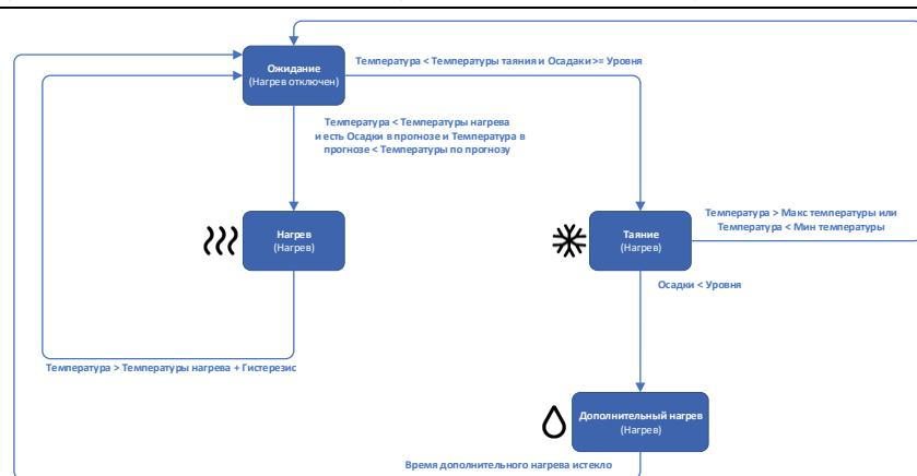
В данном примере система включает Обогрев поверхности только если в 3 часовом прогнозе погоды есть наличие осадков и температура воздуха ниже заданной в поле **Температура нагрева по прогнозу погоды**. Таким образом происходит существенная экономия электроэнергии. Обогрев поверхности в данном случае происходит до температуры заданной в поле **Температура нагрева + Гистерезис**.
