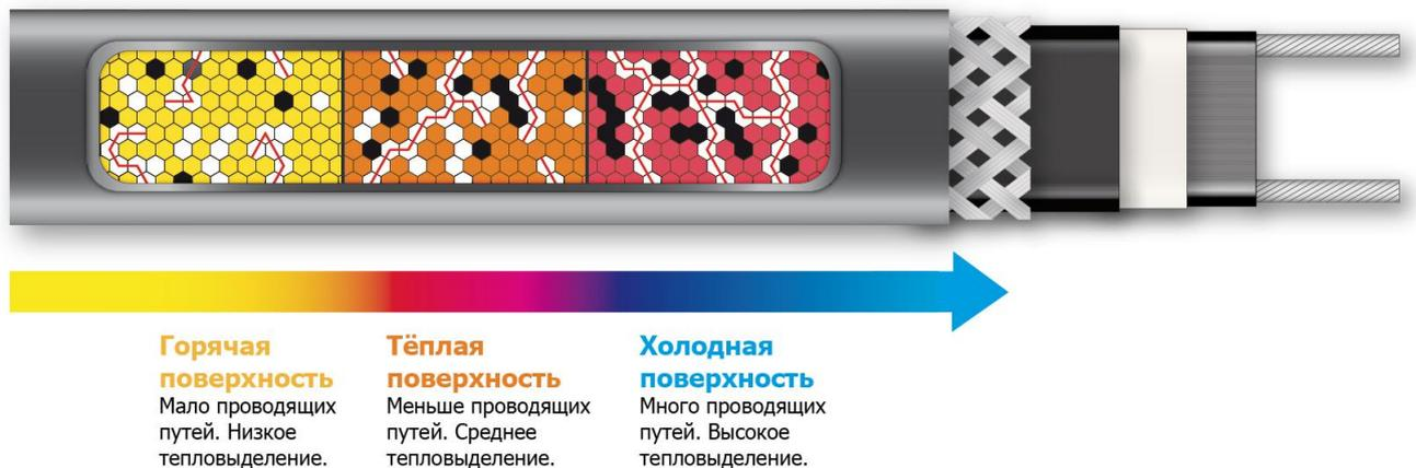
Таким образом, выходная мощность зависит от условий окружающей среды по длине обогреваемой поверхности. Эффект саморегулирования не позволяет кабелю перегреваться, дает возможность установки его внахлест без риска замыкания и возгорания кабеля, тем самым обеспечивает безопасность его применения.
